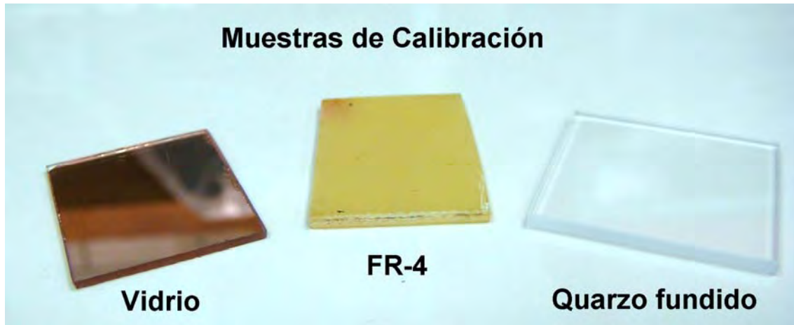
Fig. 4.4.2. Muestras de calibración utilizadas en las mediciones capacitivas. El vidrio tiene una película de cobre en una de sus superficies.
