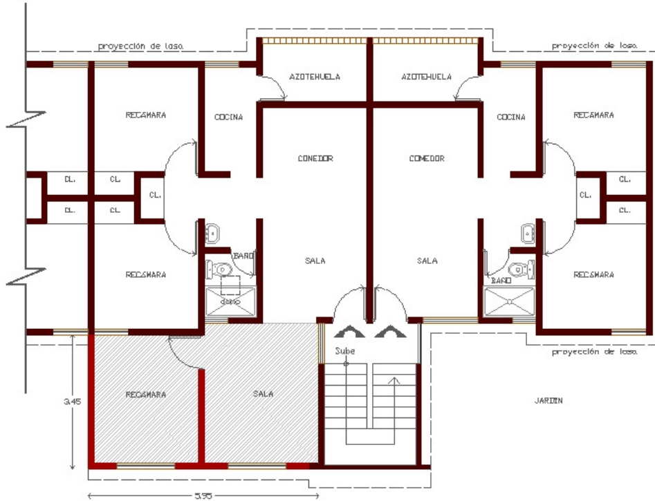
Figura 30. Planta tipo en cuarto nivel con ampliación.
