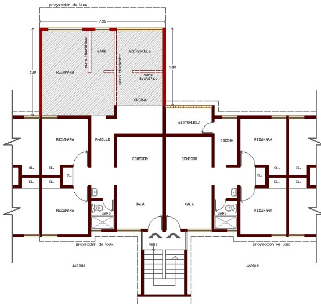
Figura 28. Planta tipo en tercer nivel con ampliación.
