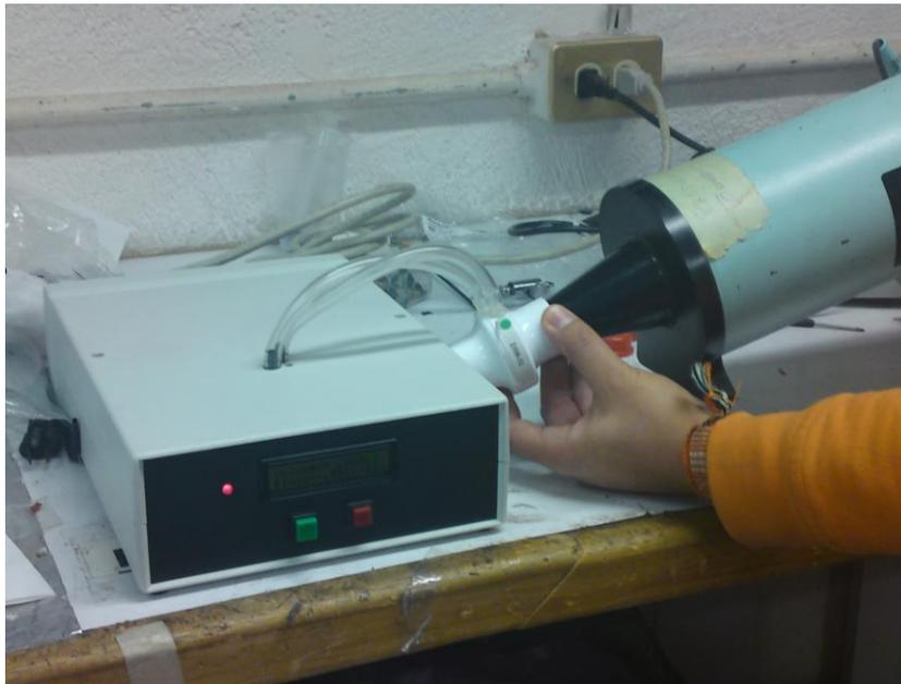
*Figura 45. Pruebas de calibración y medición realizadas sobre el prototipo final del espirómetro desarrollado.*
