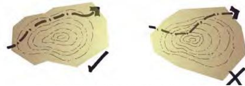
IMAGEN 29. Trazo de vialidades siguiendo las curvas de nivel, para adecuarse al paisaje y evitar cortes o rellenos. Fascículo 9, turismo alternativo, SECTUR, México D:F., pp. 33
