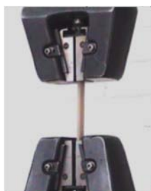
Figura 6.16. Colocación de probeta en mordazas para prueba de tensión.
