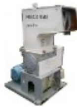
Figura 6.6. Molienda de material gelatinizado en molino Pagani.
