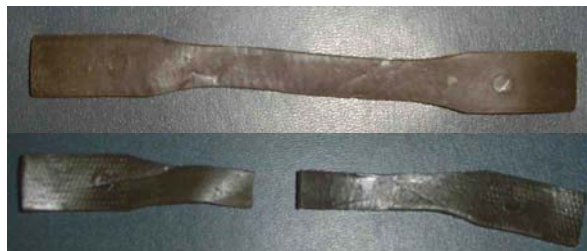
Figura 7.18. Probetas de pruebas de tensión-elongación antes y después de la prueba en la máquina INSTRON.
