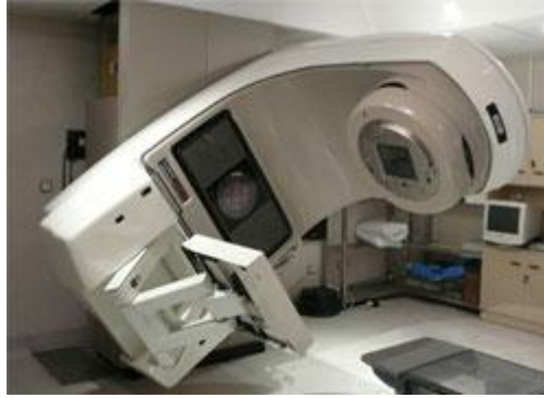
Figura 3.1 Varian Portal Vision con EPID
