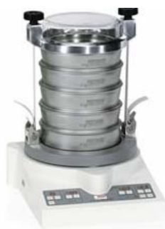
Figura 3-1 Tamizador (FRITSCH ANALYSETTE 3 PRO) utilizado en la preparación de los especímenes para los análisis químicos
