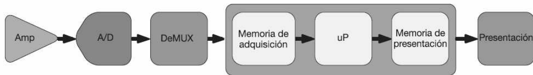
Figura 2.9. Arquitectura de procesamiento en serie de un osciloscopio digital DSO.
