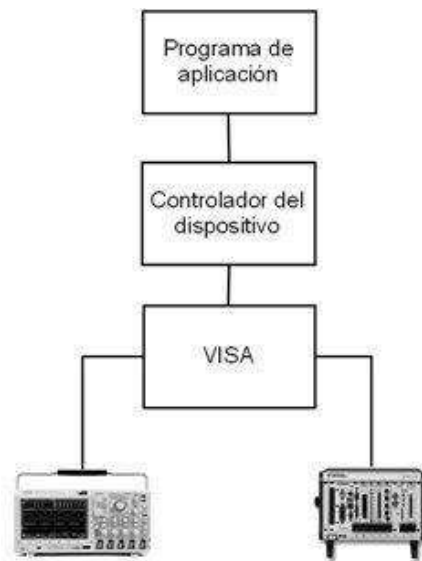
Figura 3.7. Comunicación a través de NI-VISA.
