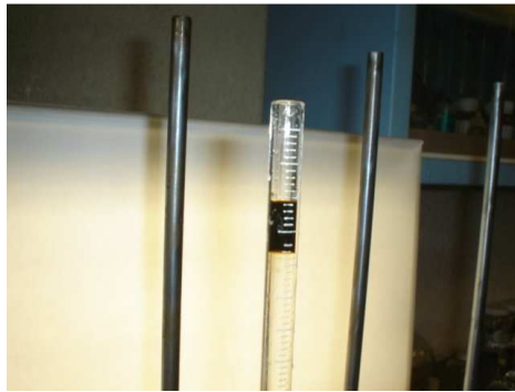
Figura 2.5 Fotografía del tubo capilar graduado.
