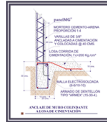
IMAGEN 18. Anclaje de muro
