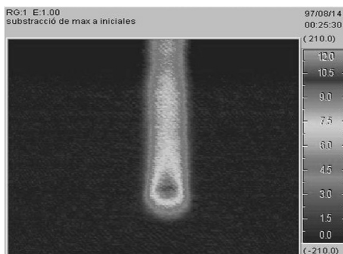
Figura 3.13.- Termografía de rayos infrarrojos de una barra de refuerzo a tensión.
