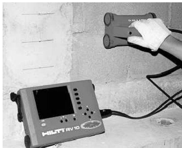
Figura 3.12.- Moderno equipo para localizar barras de acero, y para determinar su diámetro y profundidad.
