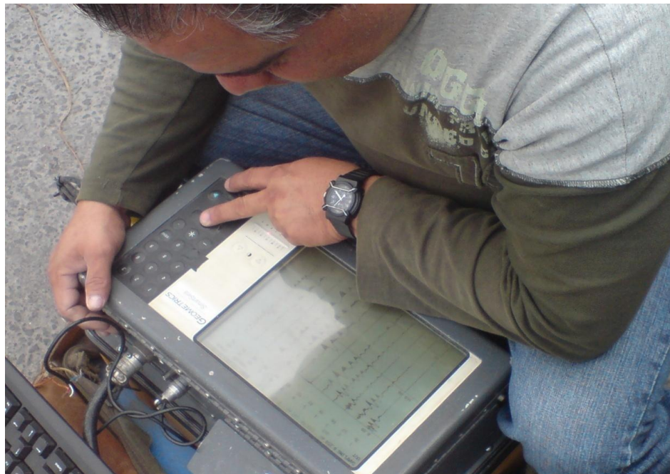
Figura 22. Control de calidad de los registros sísmicos durante la operación en campo.
