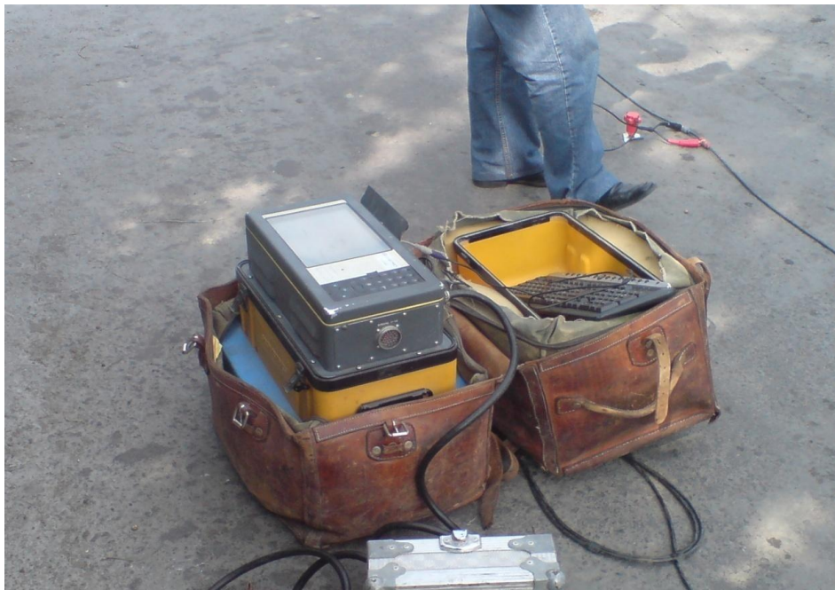
Figura 17. Sismógrafo marca Geometrics empleado para el estudio geosísmico en la avenida de Huitzilopochtli.
