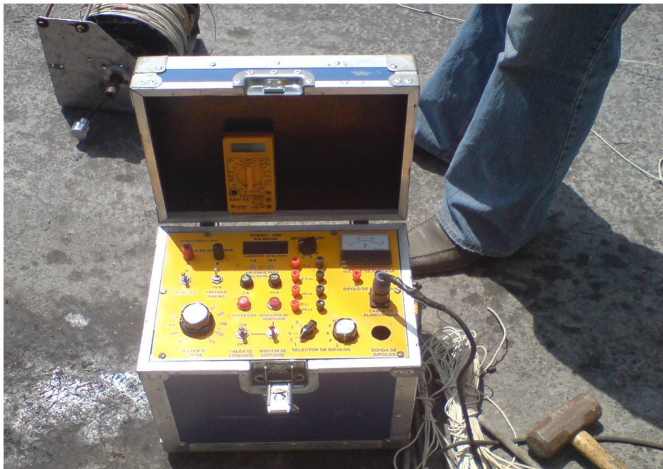
Figura 33. Equipo de resistividad empleado para realizar los estudios de resistividad en las avenidas de Huitzilopochtli, Otoño y Verano.
