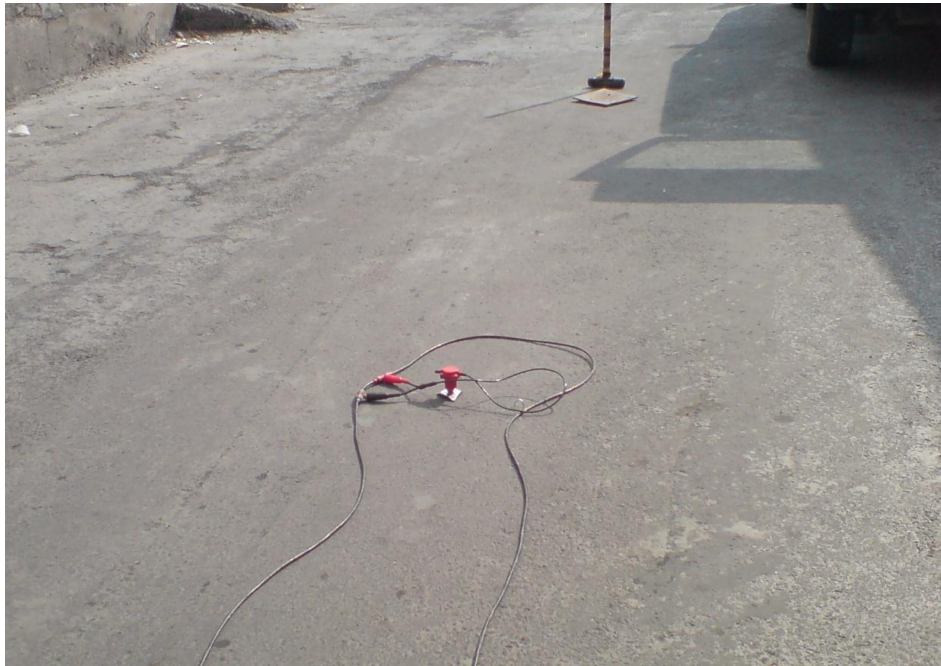
Figura 16. Geófono de 4.5 Hz empleado para el registro de las ondas elásticas que se propagan por el subsuelo debido al impacto del marro.
