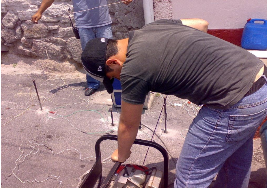
Figura 15. El equipo de resistividad se alimenta de una planta que genera la corriente eléctrica que se hace fluir por el subsuelo de la zona de estudio, SEV-5, sobre avenida Otoño.
