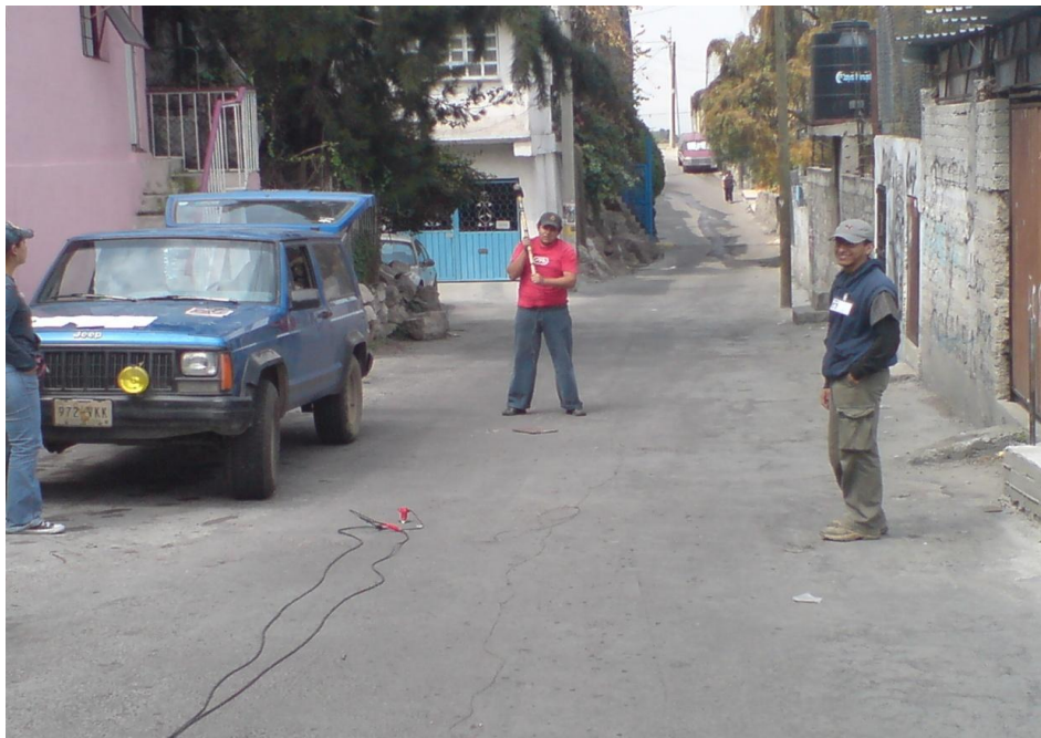
Figura 21. Punto de impacto común para los TRS-1 y TRS-2. Se muestra una sección en corte en peligro de derrumbe sobre la avenida Huitzilopochtli
