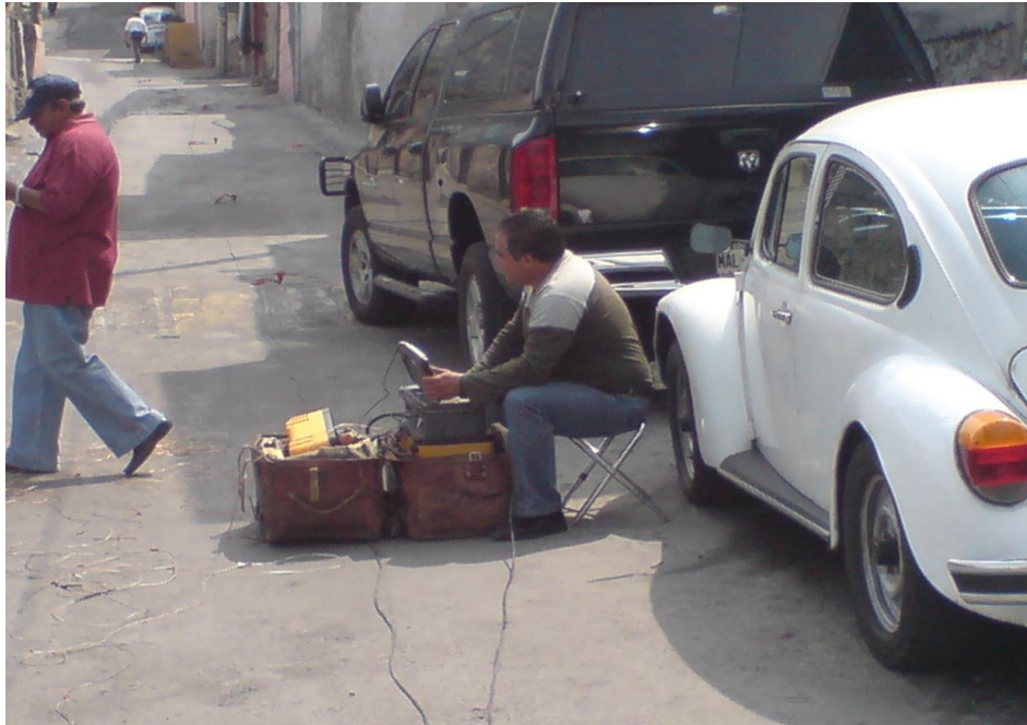
Figura 20. Operación del sismógrafo de doce canales durante la realización del Tendido de Refracción Sísmica, TRS-2, sobre la avenida Huitzilopochtli.
