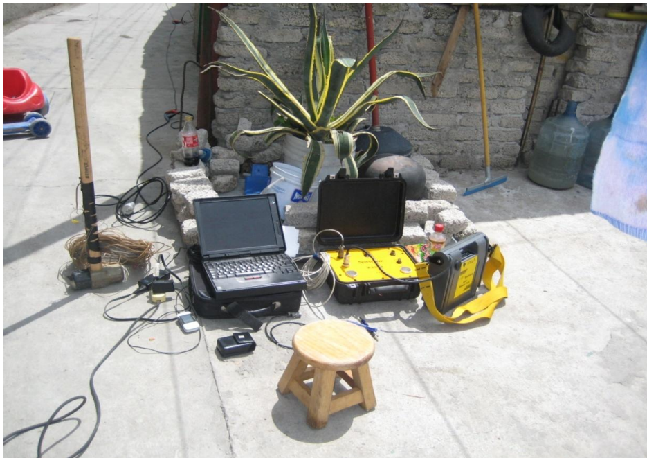
Figura 30. Estación base correspondiente al Tendido de Refracción Sísmica, TRS-7, realizado en el callejón Pino.
