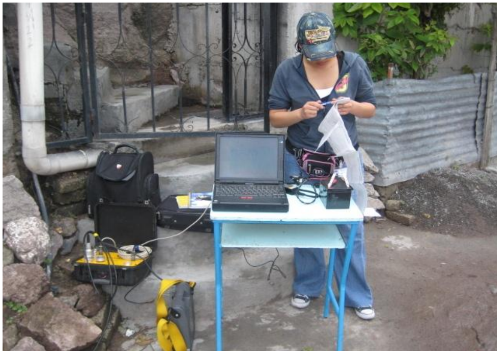
Figura 25. Estación base para los Tendidos de Refracción Sísmica, TRS-5 y TRS-6, realizados en la avenida de Otoño.
