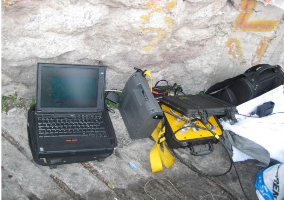
Figura 24. Sismógrafo y computadora portátil empleados para la realización de los Tendidos de Refracción Sísmica en la avenida de Otoño y en el callejón Pino.
