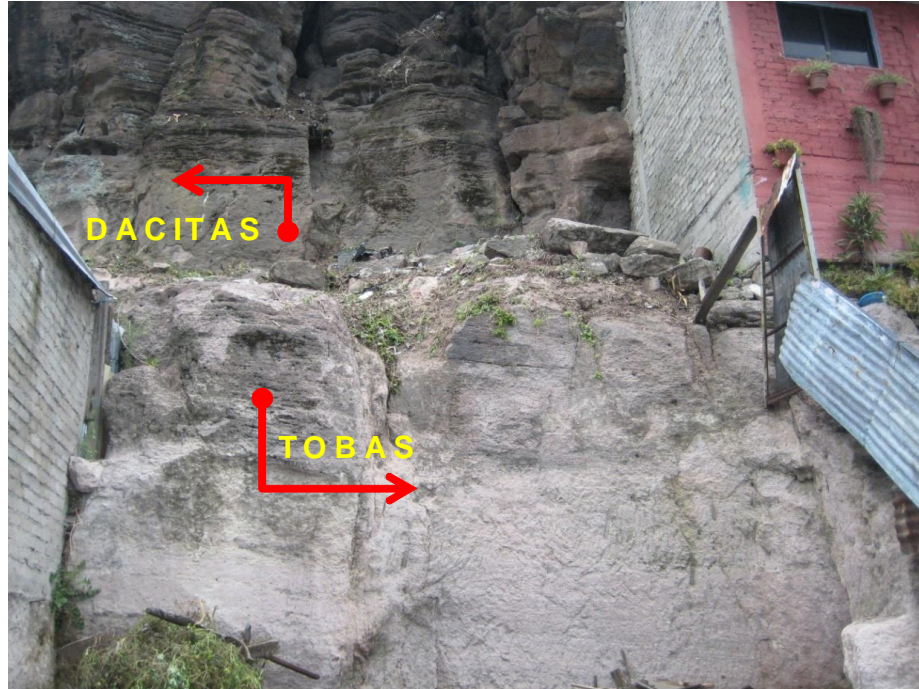
Figura 36. Manzana 16 – Lote 22. Afloramiento del contacto entre las dacitas (porción superior) y las tobas (porción inferior), ambas de buena calidad.
