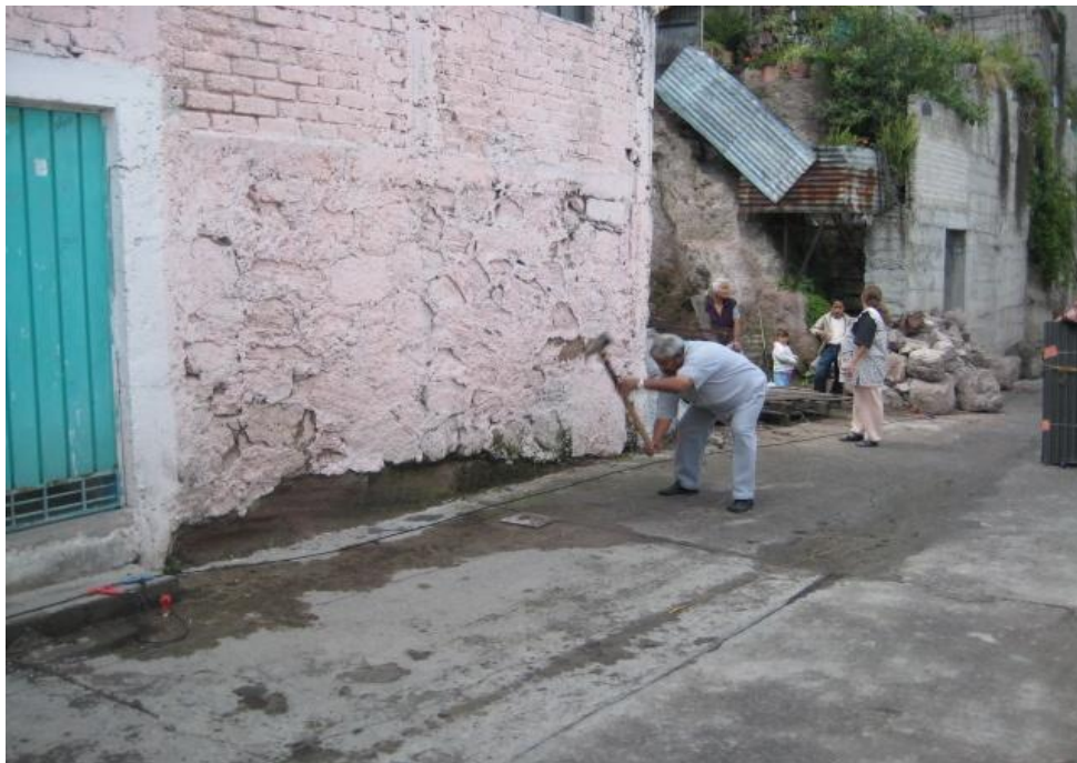
Figura 27. Punto de Tiro central para el Tendido de Refracción Sísmica, TRS-5, sobre la avenida de Otoño
