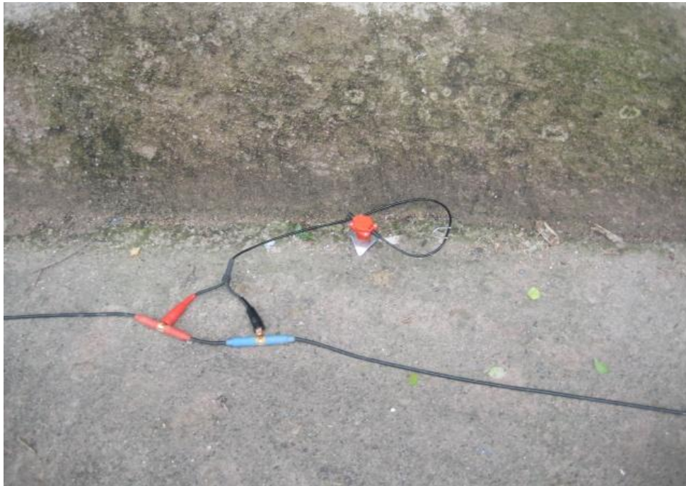
Figura 26. Detector sísmico (geófono), de 4.5 Hz empleado para detectar la vibración del terreno debida al impacto del marro sobre el terreno.
