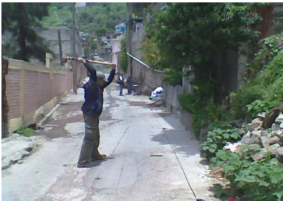
Figura 29. Segundo Punto de Tiro del Tendido de Refracción Sísmica, TRS-6, sobre la avenida de Otoño, se muestra a un costado una sección en corte, en riesgo para el paso de vehículos.
