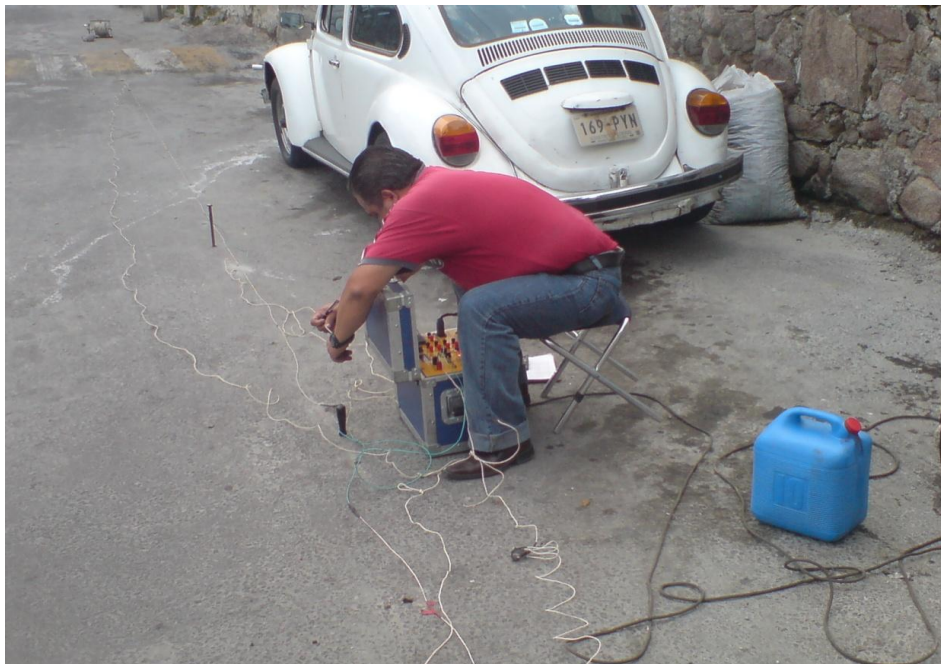
Figura 14. El equipo de resistividad permite controlar la corriente suministrada al terreno y medir la diferencia de potencial entre los electrodos. Con estos parámetros es posible calcular la resistividad aparente del terreno, SEV-5, sobre avenida Otoño.
