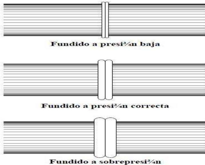
Figura 1.2 Unión por Termofusión en tubería de Polietileno
