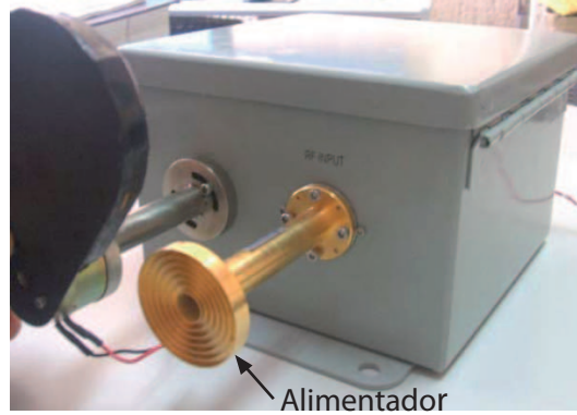
Figura 3.2: Fotografía del receptor de 43 GHz, los elementos del diagrama a bloques de la Figura 3.1 se encuentran dentro de la caja, en la foto se muestra el alimentador unido con una guía de onda al receptor.
