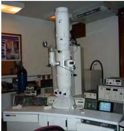
Figura (3.1-a). Microscopio de Transmisión (TEM)
