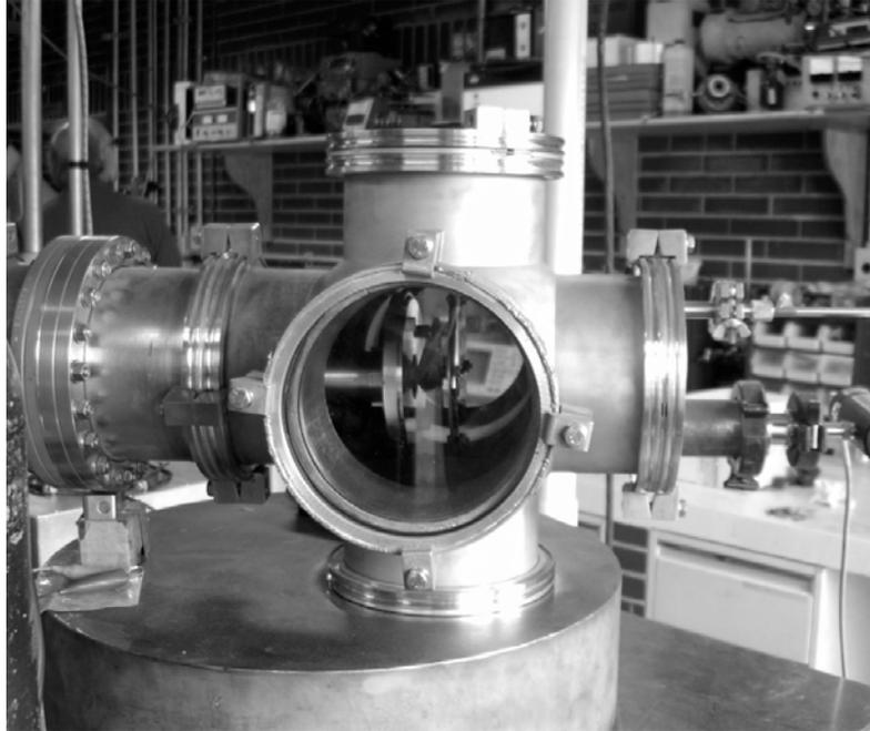
Figura (4.1.1.5-1). Cámara de vacío tipo campana, utilizada en esta tesis
