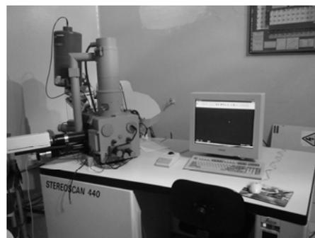
Figura (3.1-b). Microscopio de barrido (SEM)
