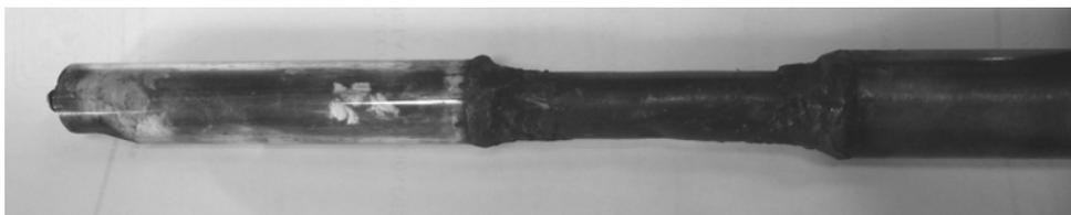
Figura No. (4.1.1.2-1). Ánodo de grafito de 19mm de diámetro, montado al tubo de cobre
