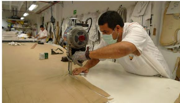
Una vez aprobados los moldes, la tela se tiende en mesas construidas bajo especificaciones ya delimitadas, después de tender la tela es cuando se pasa al proceso de corte, a continuación se enlistan los defectos más visibles del corte:
