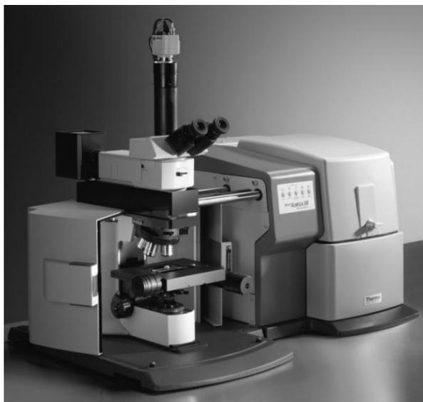
**Figura II.6** Espectrómetro Raman Nicolet Almega XR acoplado al microscopio BX51 (tomado de <http://www.thermo.com>)
