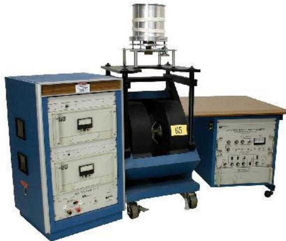
Figura II.9 Magnetómetro de muestra vibrante LDJ 9500.
