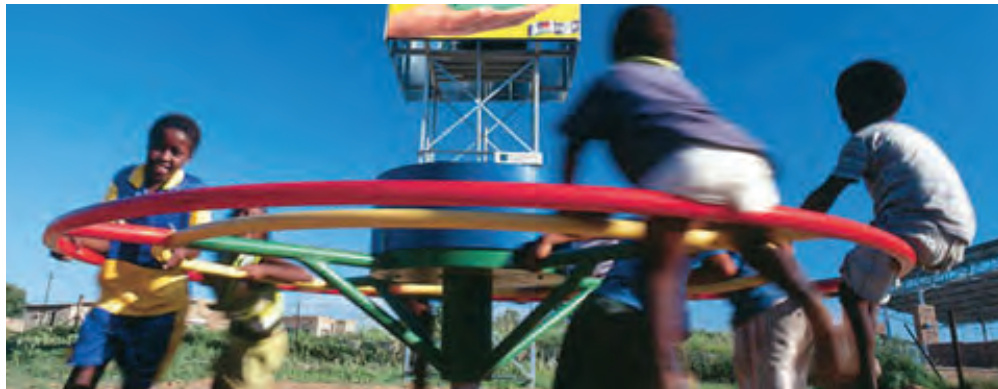
Fotografía 16 - El sistema de Playpump permite la extracción de agua subterránea con el movimiento circular realizado por los niños.
