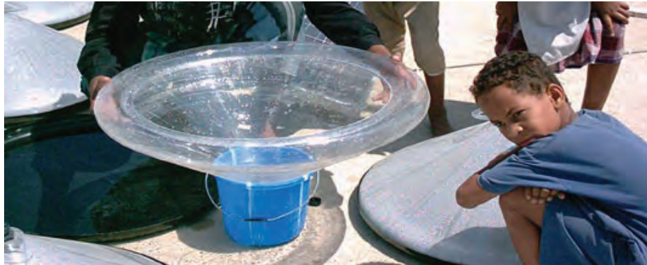
Fotografía 12 - Un pequeño cono plástico es el producto del diseño que permite la obtención de agua destilada lista para beber de forma fácil, eficaz, y económica.
