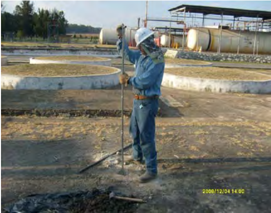
Fotografía 13. Muestreo de suelo en el sondeo SB-14
