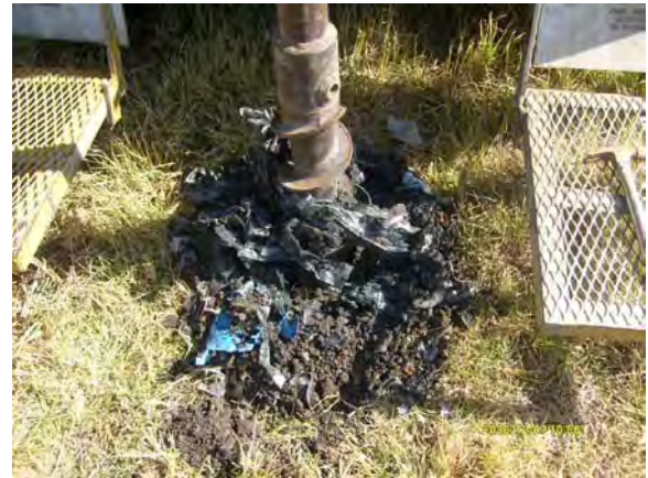
Fotografía 24. Muestreo de suelo en el sondeo SDN-5, se observa residuos plásticos
