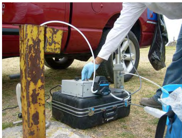
Fotografía 6. Muestreo de método de bajo flujo
