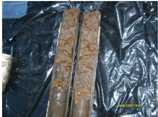
Fotografía 28. Muestreo de suelo en sondeo SDN-8, se observa fracturamiento con oxidación
