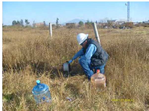
Fotografía 40. Toma del nivel de piezométrico en el pozo pmz-27
