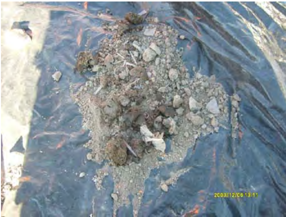
Fotografía 23. Muestreo de suelo en el sondeo SDN-4, se observa residuos plásticos.
