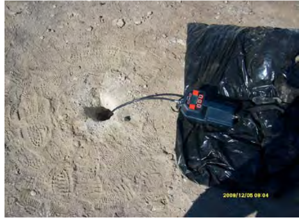
Fotografía 20. Medición de vapores orgánicos (ppm) y explosividad
