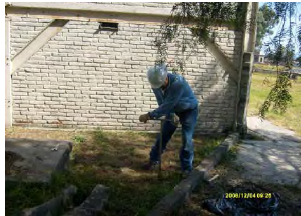
Fotografía 12. Muestreo de suelo en el sondeo SB-11
