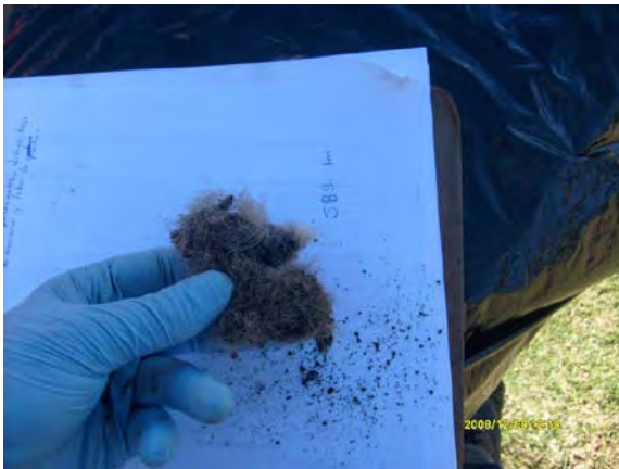
Fotografía 35. Fibra de plástico recuperado del material de recorte del sondeo SDS-3
