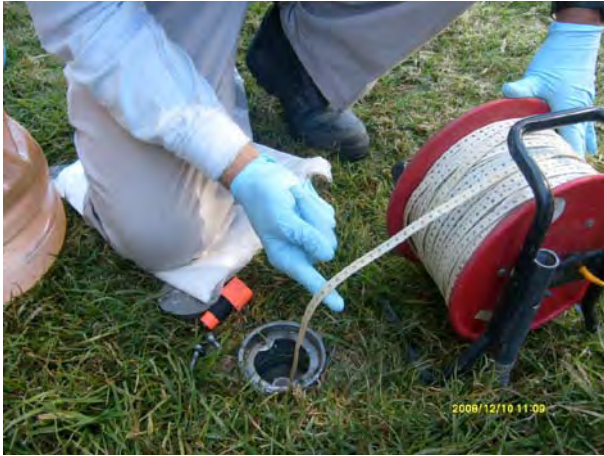
Fotografía 37. Verificación del nivel de agua en el pozo PMZ-9
