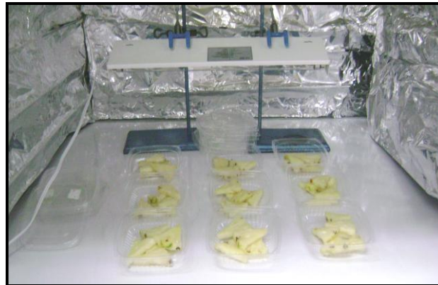
Figura 20. Aplicación de tratamientos con irradiación UV-C
