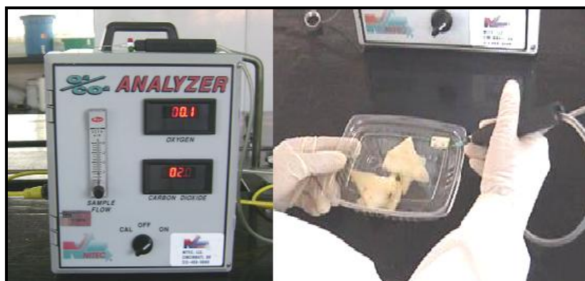
Figura 26. Determinación de la respiración con analizador de gases
