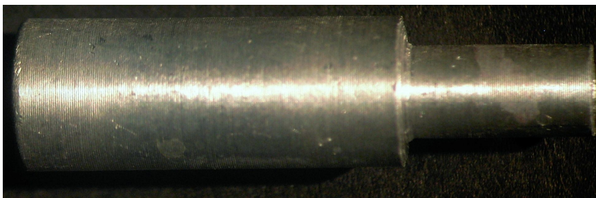
Figura 3.3.1 Probeta de Al-Li-Hf No. 2 correspondiente a la sección 1, con un tiempo de exposición de 10s.
