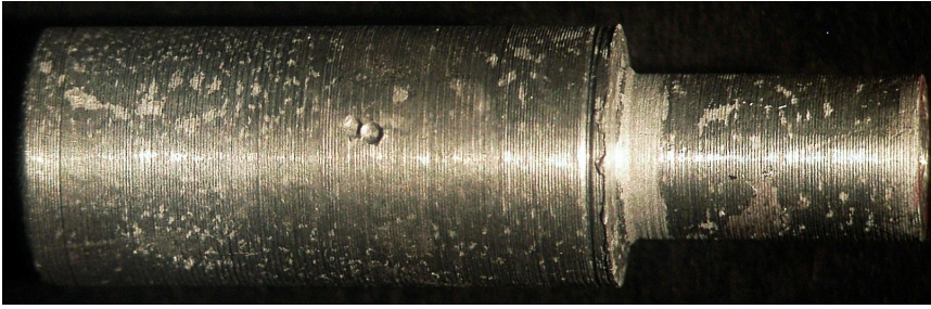
Figura 3.3.2 Probeta de Al-Li-Hf No. 9 correspondiente a la sección 2, con un tiempo de exposición de 100,000s.
