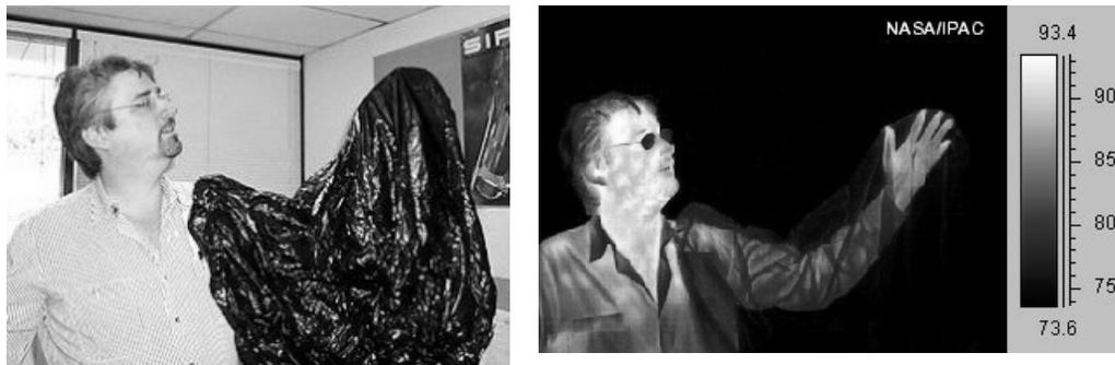
En las imágenes de arriba tenemos una vista óptica (en luz visible, izquierda) y una vista infrarroja (derecha) de la mano de una persona dentro de una bolsa de plástico.
