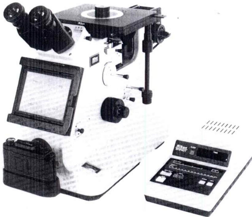
Figura 3.1 Microscopio óptico metalúrgico de platina invertida
