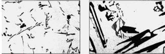
Clase 1: Estructura sin modificar. El silicio está presente como láminas largas, gruesas y de forma acicular.
