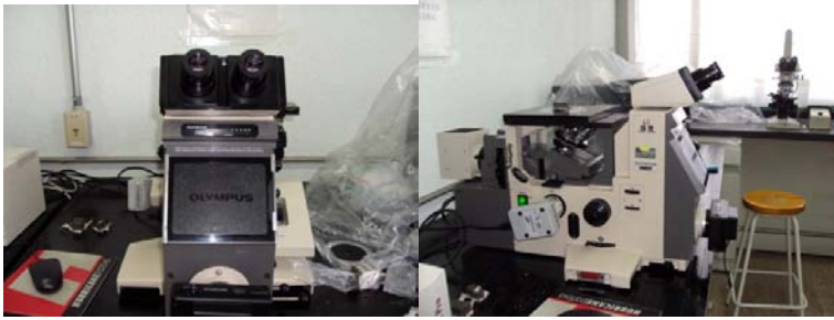
Figura 4.4. Microscopio metalúrgico de platina invertida.
