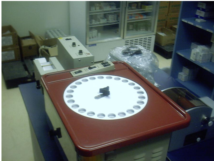
Figura 13: “Máquina reenvasadora de tabletas.”
