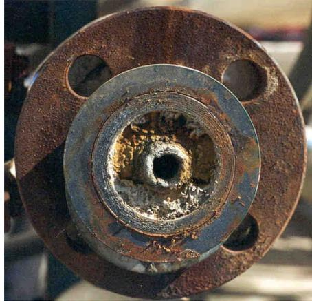
**Figura 3.24 Tubería corroída y con incrustaciones.**
