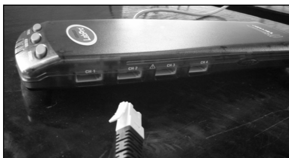
Figura 2.pH. Terminación del Sensor de pH para conectarlo en el cerebro LabPro.
