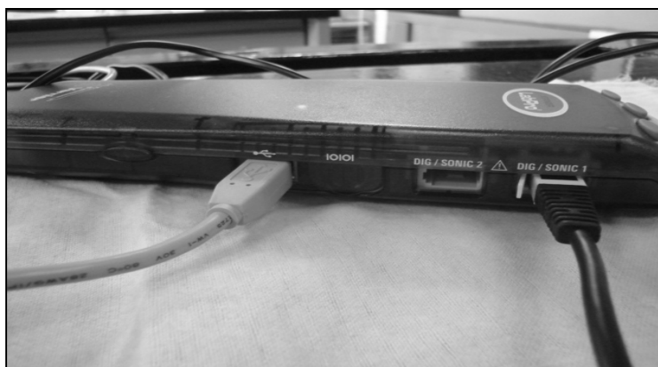
Figura 5.C-G. Conexión del Cuenta Gotas en la entrada Dig/Sonic 1 del cerebro LabPro.
