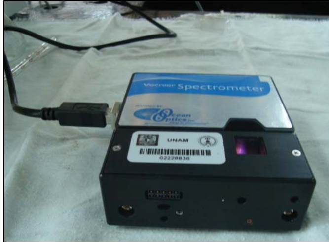
Figura 12.ESP. Espectrómetro conectado por cable USB a la computadora.
