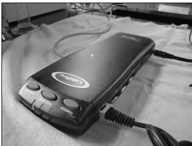
Figura 2. ORP. Sensor conectado al cerebro LabPro en cualquier canal análogo.
