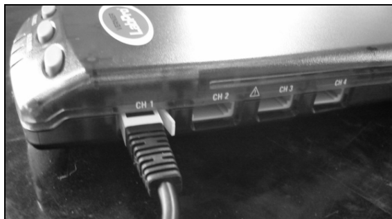
Figura 3.pH. Conexión del sensor de pH en el cerebro LabPro.
