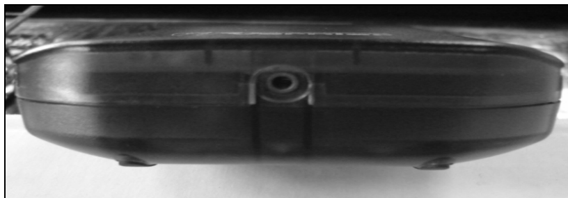
Figura 8.I. Entrada para conexión de computadora.
