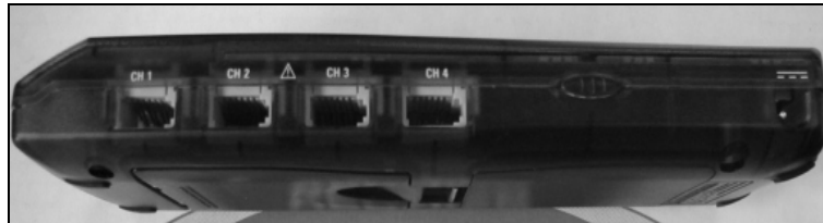
Figura 13.I. Las cuatro entradas análogas y el puerto para el adaptador de CA.
