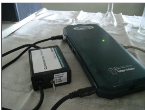
Figura 3.CON. Imagen que muestra el lugar donde se encuentra el switch del Sensor de Conductividad.
