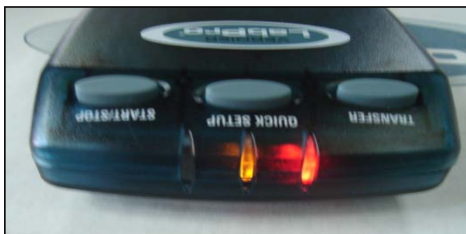
Figura 9.I. Muestra los dos primeros LEDs, la luz roja y la luz amarilla.
