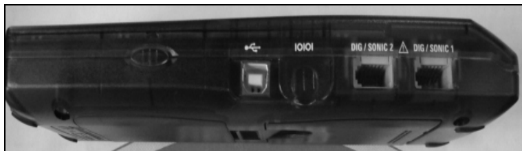
Figura 14.I. Puertos digitales, conexión serial y conexión USB.
