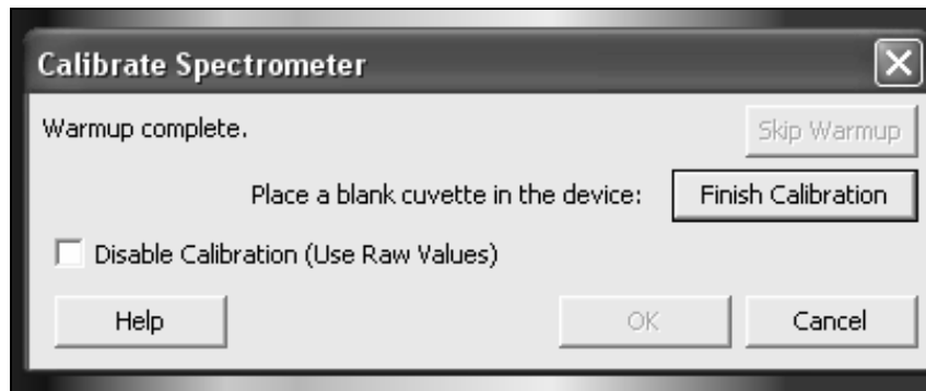
Figura 5.ESP. Imagen que muestra un recuadro para iniciar la calibración y un aviso de que el calentamiento del equipo esta completo.
