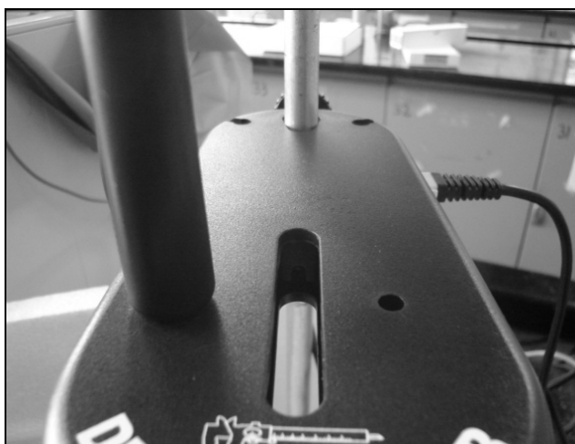
Figura 1.C-G. Ranura donde se encuentra el lector óptico de rayo infrarrojo.
