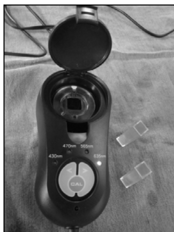
Figura 6. ORP. Seleccionando la longitud de onda en el Colorímetro para las próximas mediciones.
