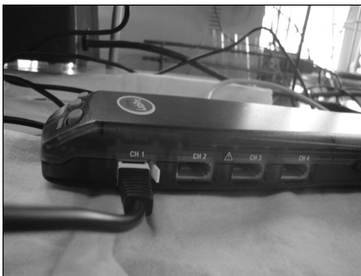
Figura 4.C-G. Conexión del Sensor de pH a la entrada CH 1 del cerebro LabPro
