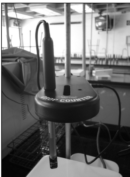
Figura 2.C-G. Imagen donde se muestra en donde se coloca el Sensor de pH.
