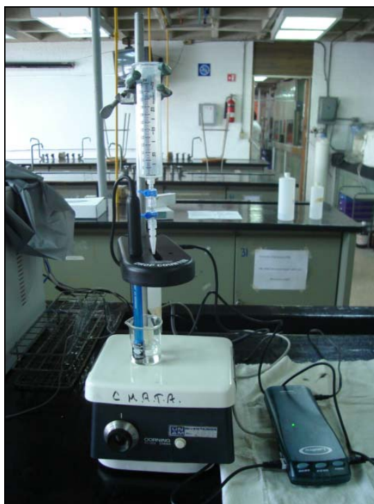
Figura 9.C-G. Montaje experimental para utilizar el Cuenta Gotas Vernier.
