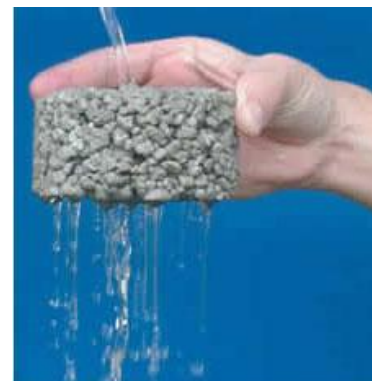
Fig. 1. La estructura vacía del concreto permeable permite fácilmente el paso del agua. (Fuente, Nacional Ready Mixed Concrete Association, USA)
