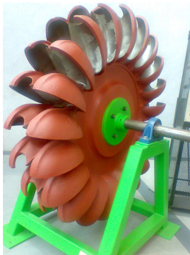
Figura 4.6 Álabes de una Turbina Hidráulica
