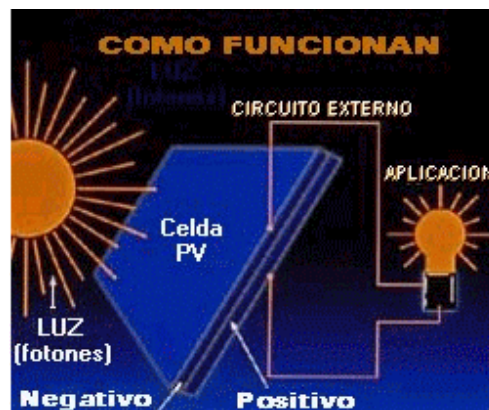
Figura 4.9 Funcionamiento de una celda fotovoltaica.
