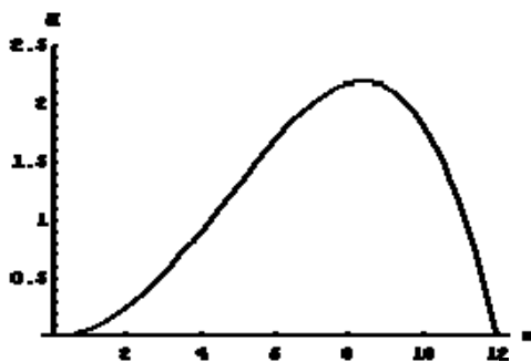
FIGURA 15a. Gráfica del momento flexionante, la función M(x) , para un arco parabólico, con a = 12\text{m} y una distribución uniforme de carga sobre el arco, \lambda = 1\text{ kg/m} . La coordenada x va desde x=0 (eje vertical) hasta x=a .
