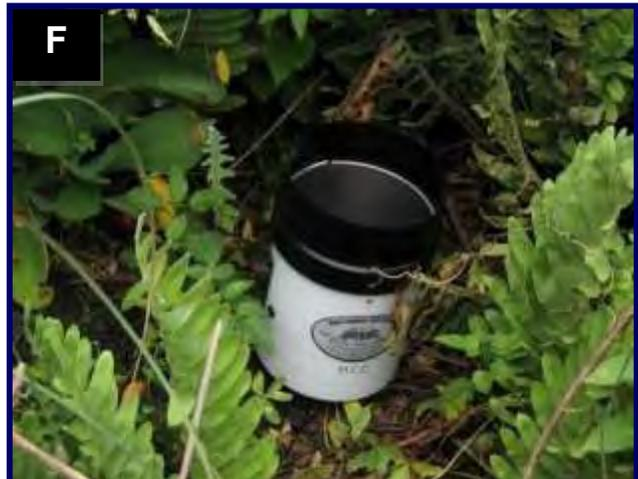
**Figura 24.** Registradores de datos HOBO-Pendant, utilizados para la medición de las condiciones microambientales. a) Temperatura, b) humedad relativa ambiental, c) radiación fotosintéticamente activa (PAR), d) humedad de suelo, e) microestación y f) pluviómetro.
