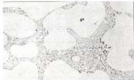
Clase 5: Estructura bien modificada. El silicio está presente en forma de partículas fibrosas redondeadas.
