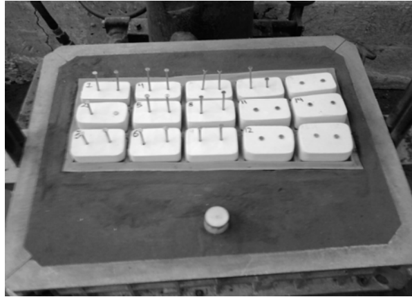
Figura 5.20 Corazones de arena sílica-silicato de sodio fijados con clavos en el molde de arena.
