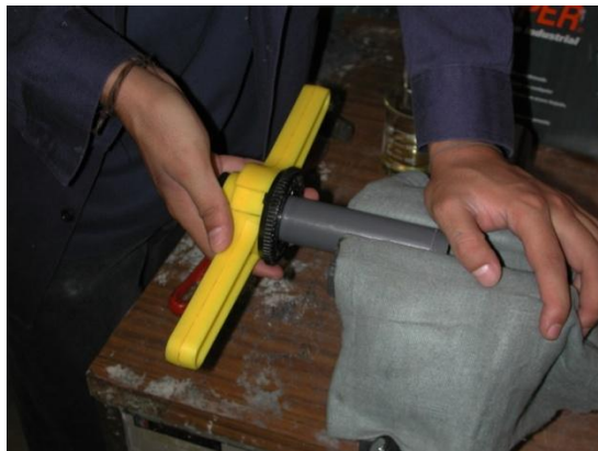
Foto 2. 2. Fabricación de cuerda a tubos de PVC.
