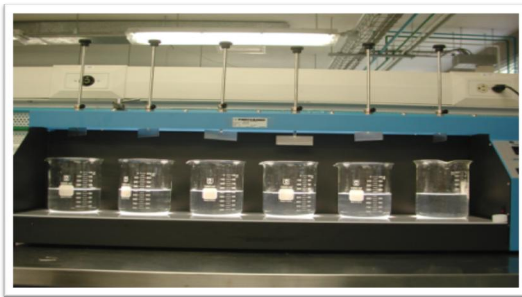
Foto 2. 10. Sistema para prueba de jarras a nivel laboratorio
