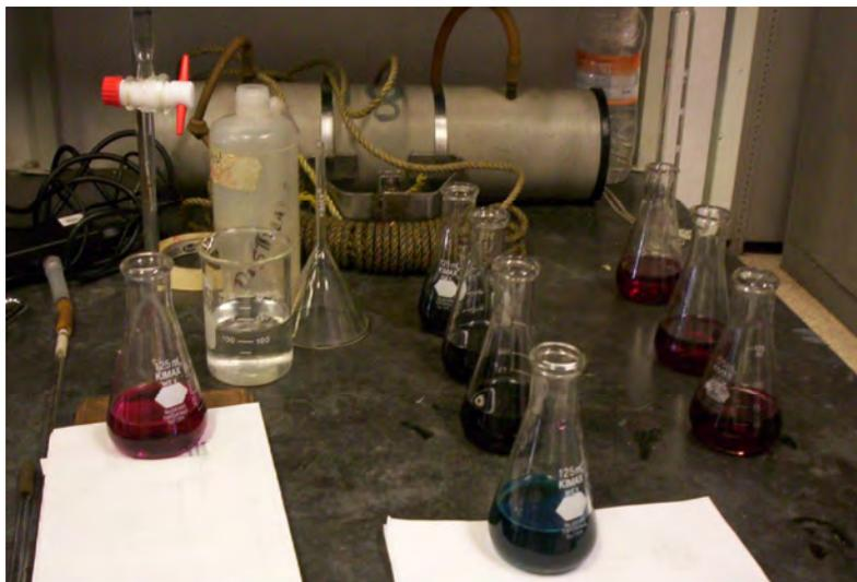
Foto No. 23. Análisis de carbonatos, bicarbonatos
