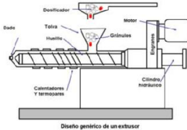
Fig. 3: Diagrama de un extrusor 8
