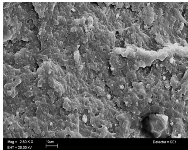
Fig. 3.25 Micrografía del PP-g-MAH 5.0 phr bentonita lisina dos pasos a 2.5Kx
