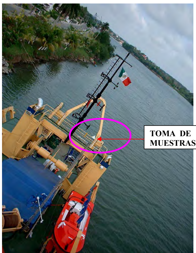
Figura 19. Torre de meteorología y toma de muestra (teflón) de contaminantes atmosféricos.
