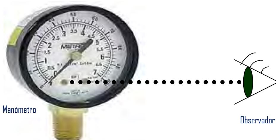
**FIGURA 16. NOS MUESTRA COMO SE DEBE TOMAR LA LECTURA PARA EVITAR EL ERROR DE PARALELAJE.**
