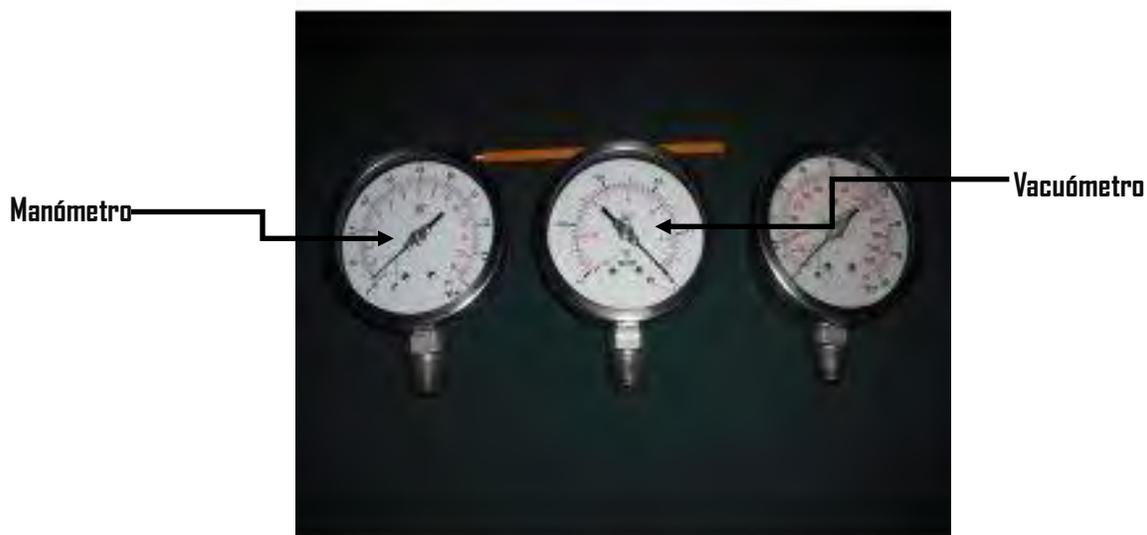
**FIGURA 9. REPRESENTA LA DIFERENCIA ENTRE UN MANÓMETRO Y UN VACUÓMETRO**
