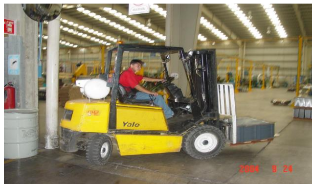
TRANSPORTE: UÑAS A UNA ALTURA NO MAYOR DE 15cm DEL PISO Y NO EXCEDER LA VELOCIDAD DE 10 Km./hr.
