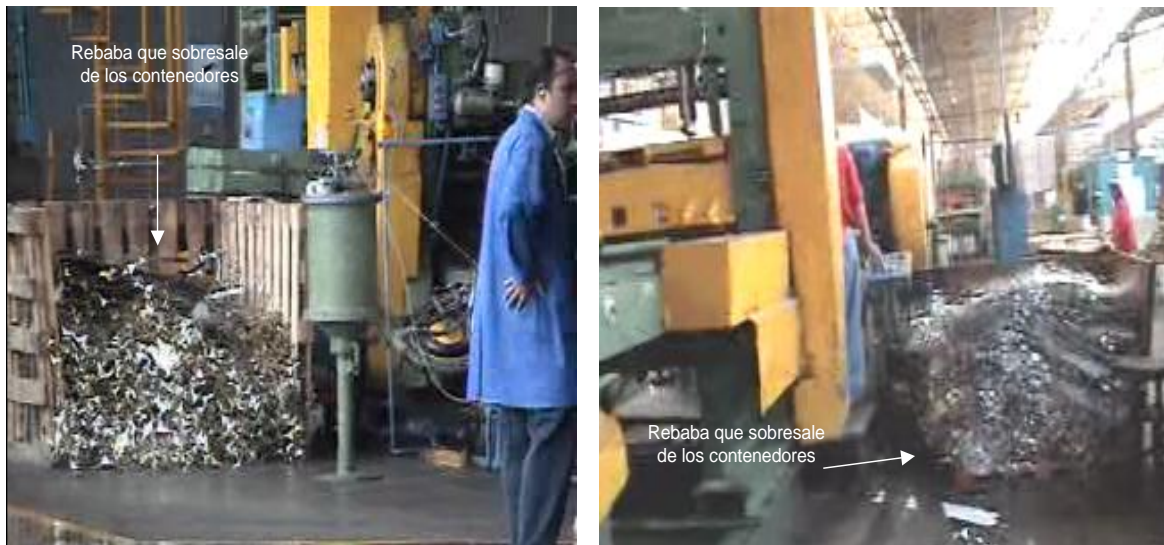
Figura 34. Contenedores con exceso de material
