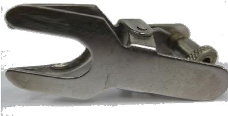
Figura 12.- Pinza utilizada para unir las celdas de difusión.
