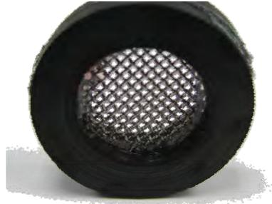
Figura 11.- Malla empleada para separar las celdas de difusión.
