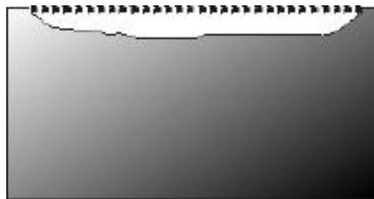
Figura1.1 Corrosión Uniforme
