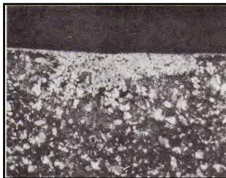
Figura 1.11 Microfotografía de un depósito de cobre en el latón, mostrando el efecto de la dezincificación (x50).
