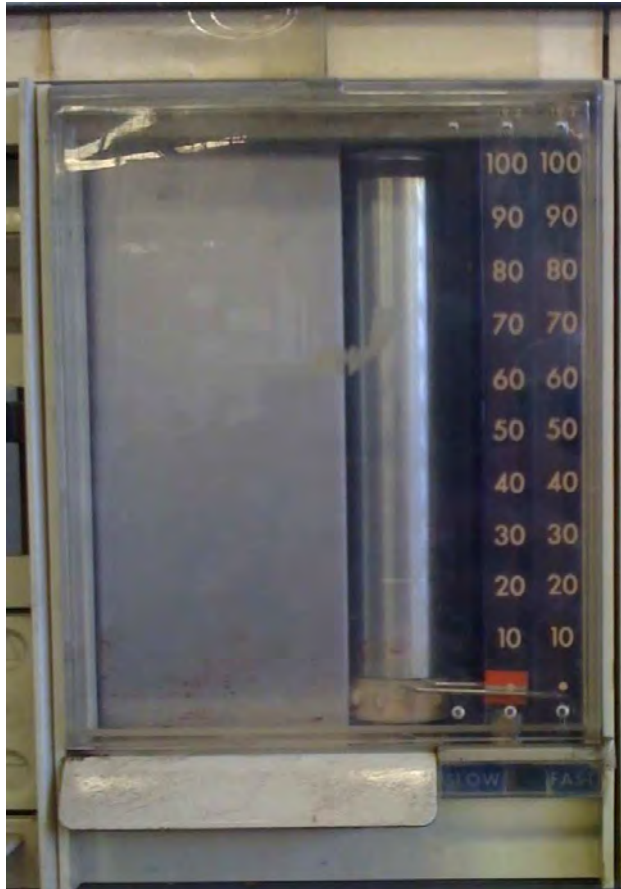
Figura 6.11 Registrador (puntero rojo: punto de ajuste, puntero azul: Señal medida).
