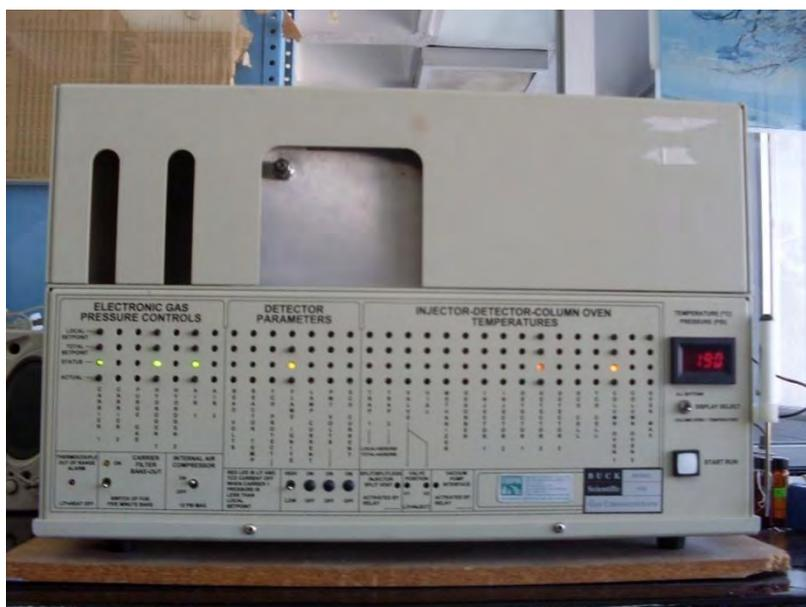
Figura 8. Fotografía del cromatógrafo de gases modelo Buck Scientific 910
