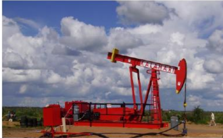
Fig. 4.6 Proceso de bombeo de agua "Dewatering"
