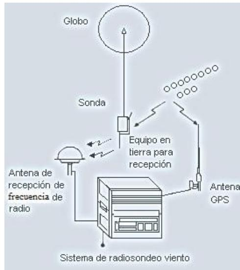
Figura 2. Equipo del radiosondeo (SMN, 2009)
