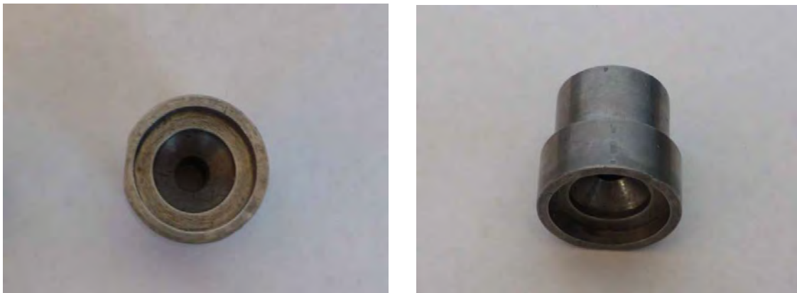
Figura 7. Dado de perfil circular con diámetro de 8 mm en diferentes vistas.
