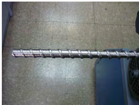
Figura 6. Tornillo de cuerda sin fin con profundidad de canal descendiente.
