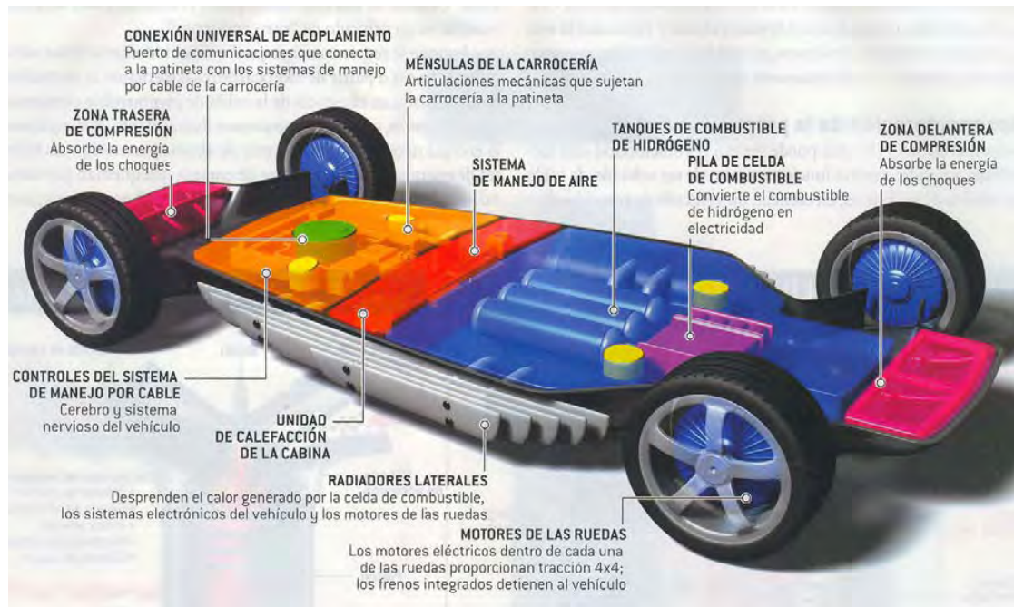
Figura 4.11. Chasis “patineta” del AUTOnomy
