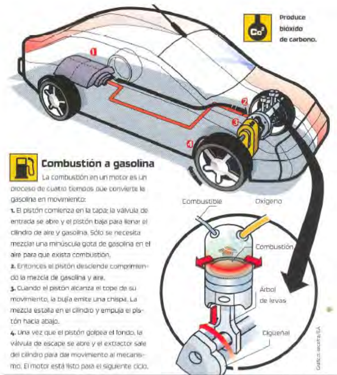
Figura 4.14. Eficiencia del motor de combustión de gasolina.
