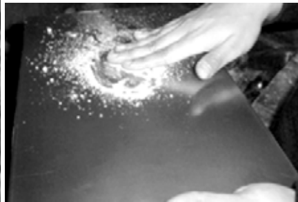
Tallar la placa con detergente y un poco de agua y enjuagar la placa.
