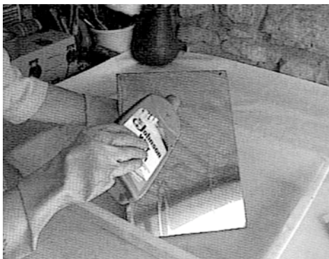
Aplicación de cera para pisos Carrefour y Johnson sobre la placa metálica,
