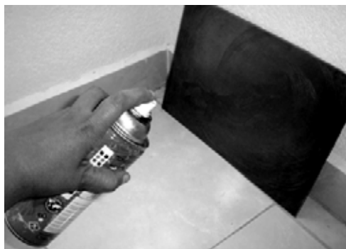
Aplicación de barniz en aerosol sobre la placa
