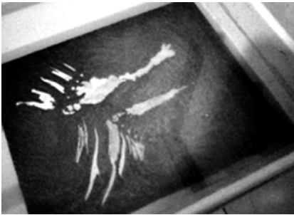
Se sumerge la placa y se lleva acabo el atacado.
