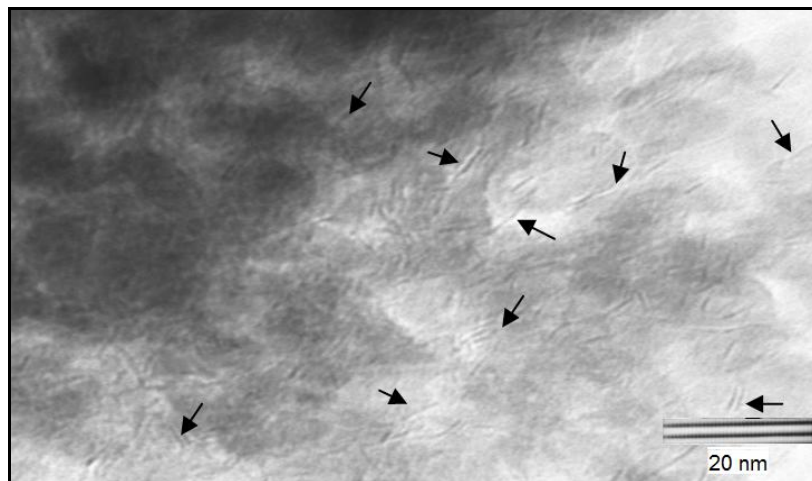
Figura 4.5 Micrografía HRTEM de NiMo. Las flechas señalan la fase de \text{MoS}_2
