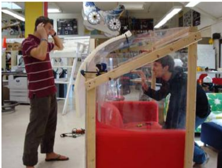
Figura 4.1. Los sonidos dentro de la cámara de policarbonato se perciben más altos, mientras que fuera de ésta casi no se escuchan
