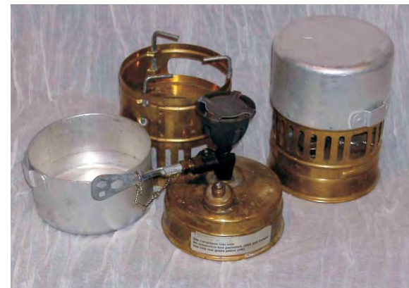
SVEA 123 , fue una estufa sueca, que estuvo en producción desde 1955 hasta los 80s y su tapa de aluminio servía como pequeña olla.
