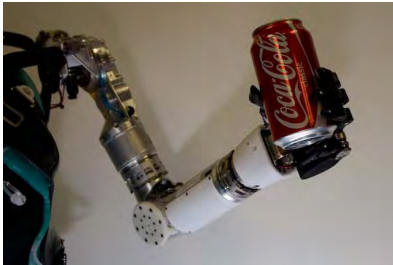
Figura 2.21 El Luke Arm tiene la capacidad de tomar un objeto empleando una fuerza controlada[34]
