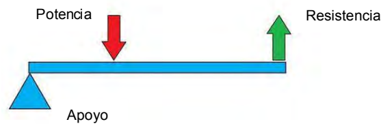
Figura B.3 Configuración de una palanca interpotente [2]
